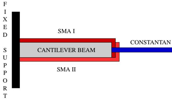
**FIGURE 11.** CANTILEVERED BEAM BIMORPH CONFIGURATION
